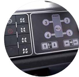
Steering control panel 转向控制面板
